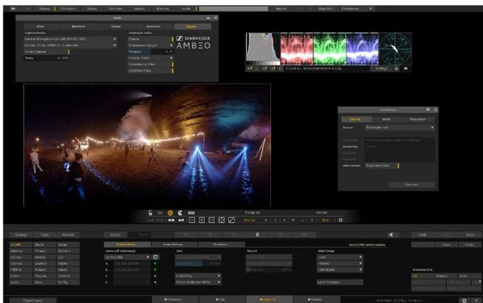
Die Software SCRATCH VR von Assimilate arbeitet mit dem AMBEO A-B Konverter. Dadurch kann das Ambisonics A-Format des AMBEO VR-Mikrofons direkt in die Software gespielt werden.
